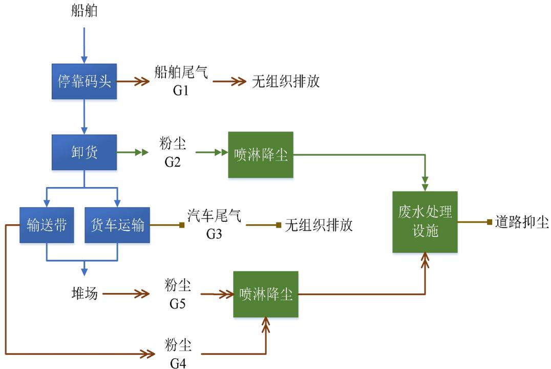
图 5-1 黄沙、石子装卸流程图
