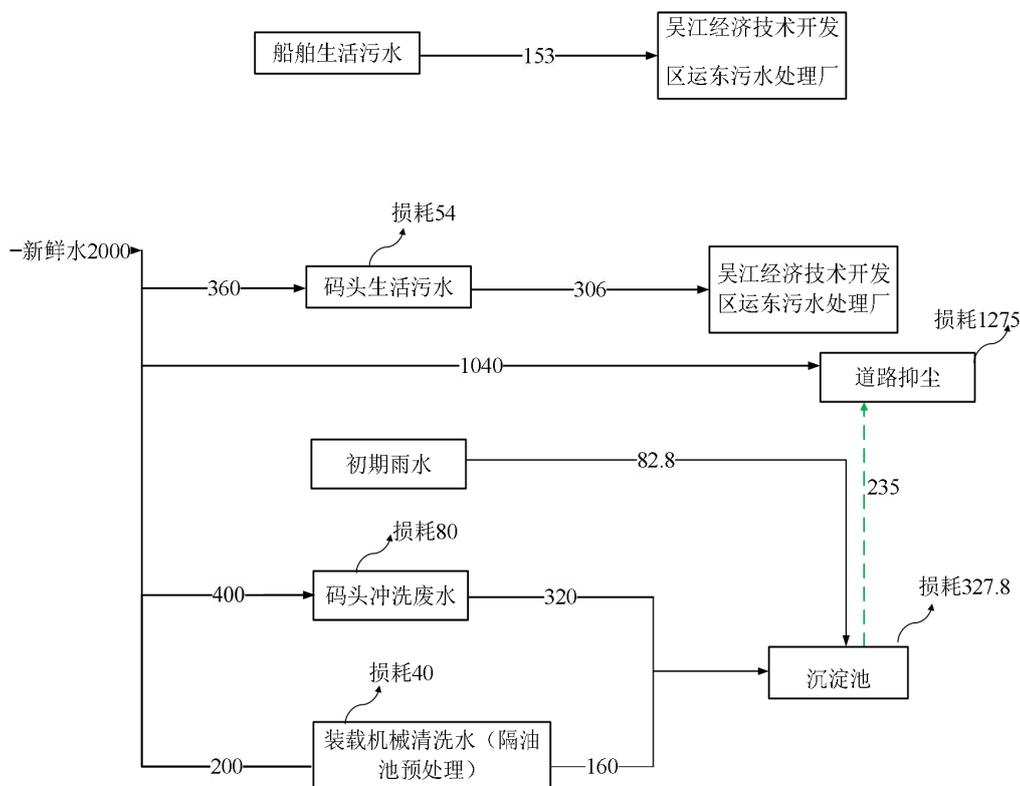
图 5-2 本项目水平衡图 单位：t/a
