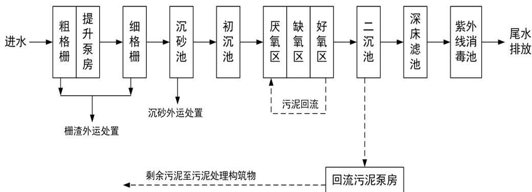
图 7-1 苏州市吴江经济技术开发区运东污水处理厂处理工艺流程图
