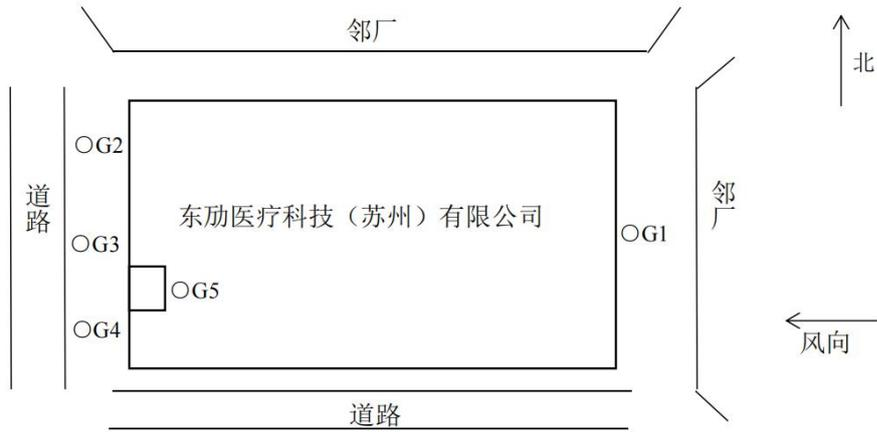
无组织废气采样点: ○G1: 厂界上风向测点; ○G2、○G3、○G4: 厂界下风向测点; ○G5: 厂区内测点。
