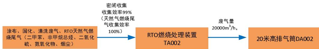
图 4-1 本项目废气处理流程图
