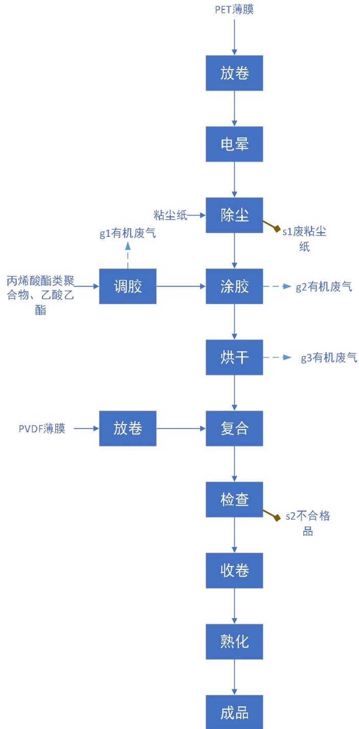
图 2-4 现有项目生产工艺流程及产污环节图
