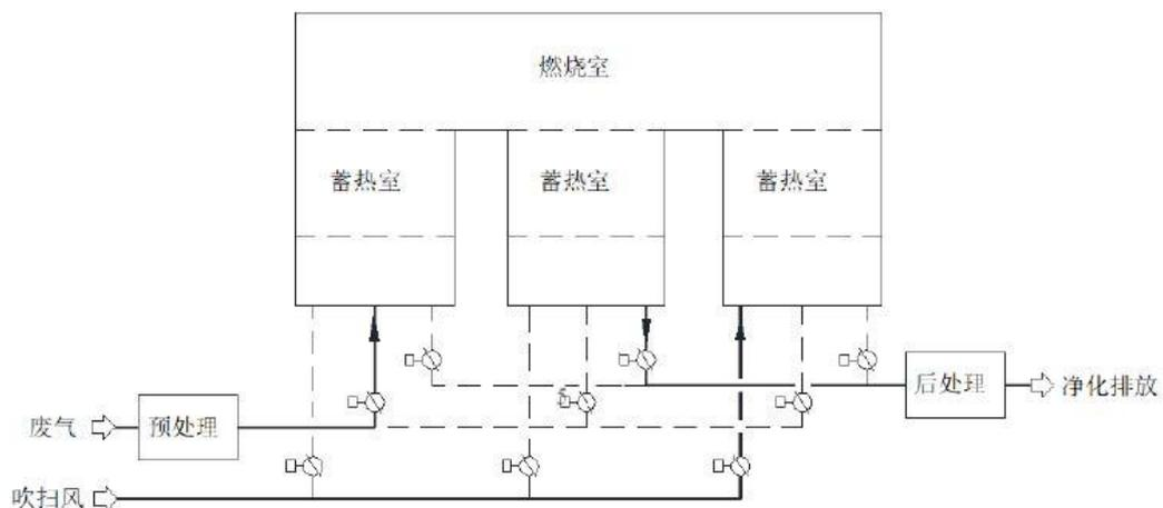
**图 4-2 RTO 燃烧处理装置示意图**
