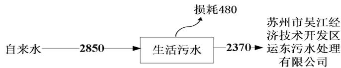
图 2-2 全厂水平衡图 (t/a)
