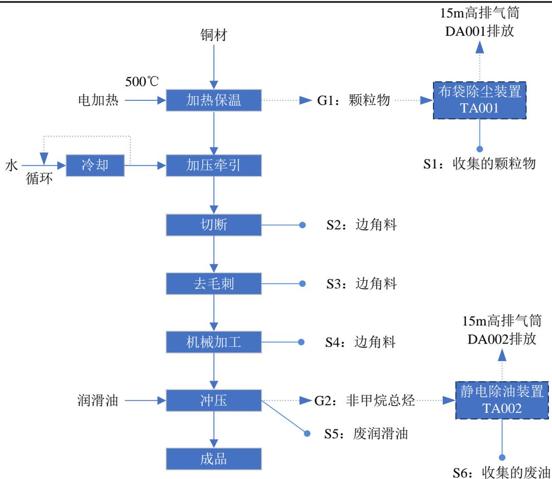
图 2-3 生产工艺流程图
