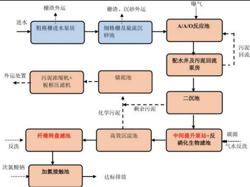
图 4-2 污水处理工艺流程图
