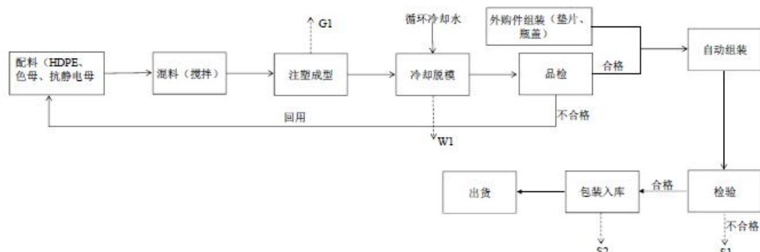
图 2-1 药用高密度聚乙烯瓶生产工艺流程图
