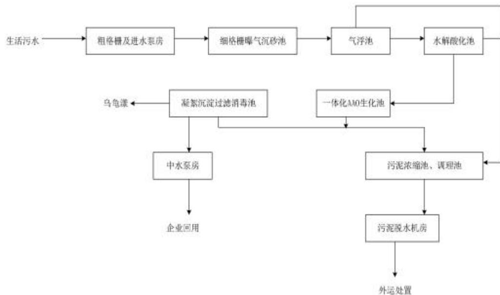
图 4-2 苏州市吴江区芦墟污水处理有限公司污水处理工艺流程图
