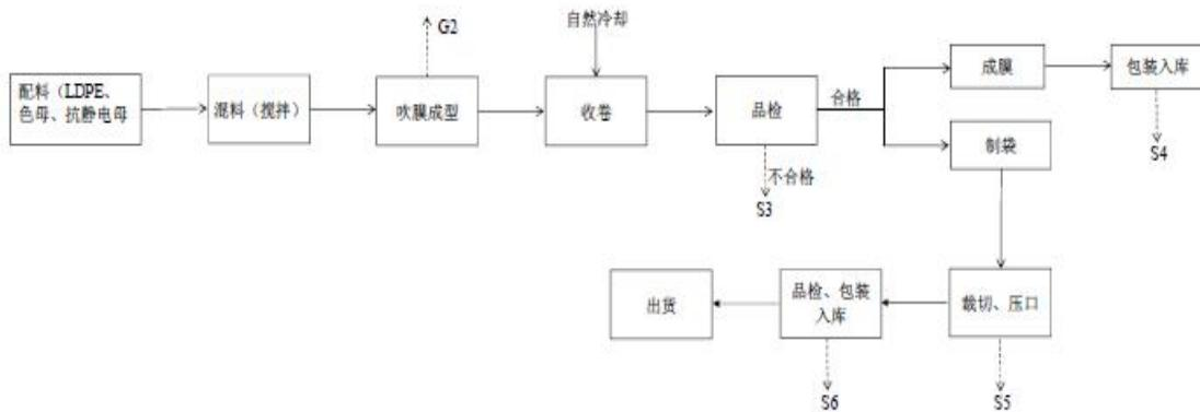
图 2-2 药用低密度聚乙烯膜（袋）生产工艺流程图
