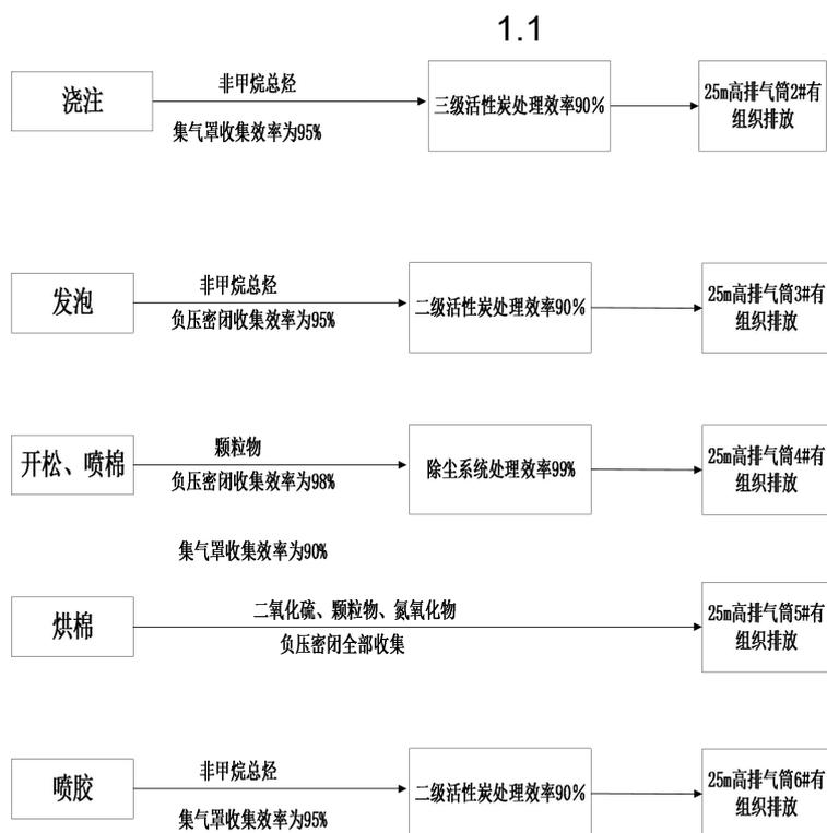
图 3-1 本次验收项目废气收集、处理、排放流程示意图
