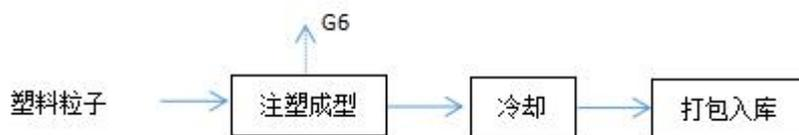
图 2-3 塑料组件生产工艺流程图
