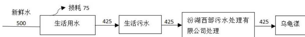
图 2-1 全厂水平衡图 (t/a)
