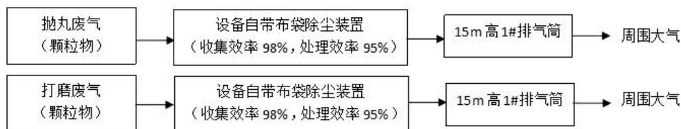
图 4-1 本项目废气收集图
