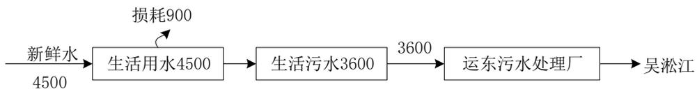
图 2-1 本项目水平衡图 (t/a)
