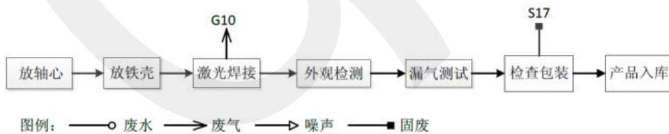
图 2-34 现有模具组装生产及产污环节示意图
