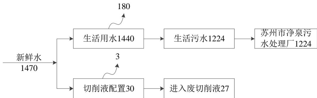
图 2-1 本项目水平衡图 (t/a)
