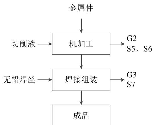
图 2-3 模具生产工艺流程图
