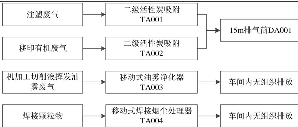
图 4-1 本项目废气处理流程图
