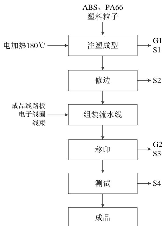
图 2-2 通信路由器生产工艺流程图
