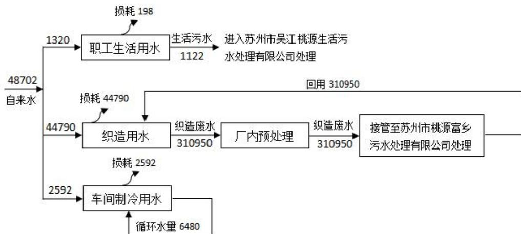
图 2-1 本项目水平衡图（单位：t/a）
