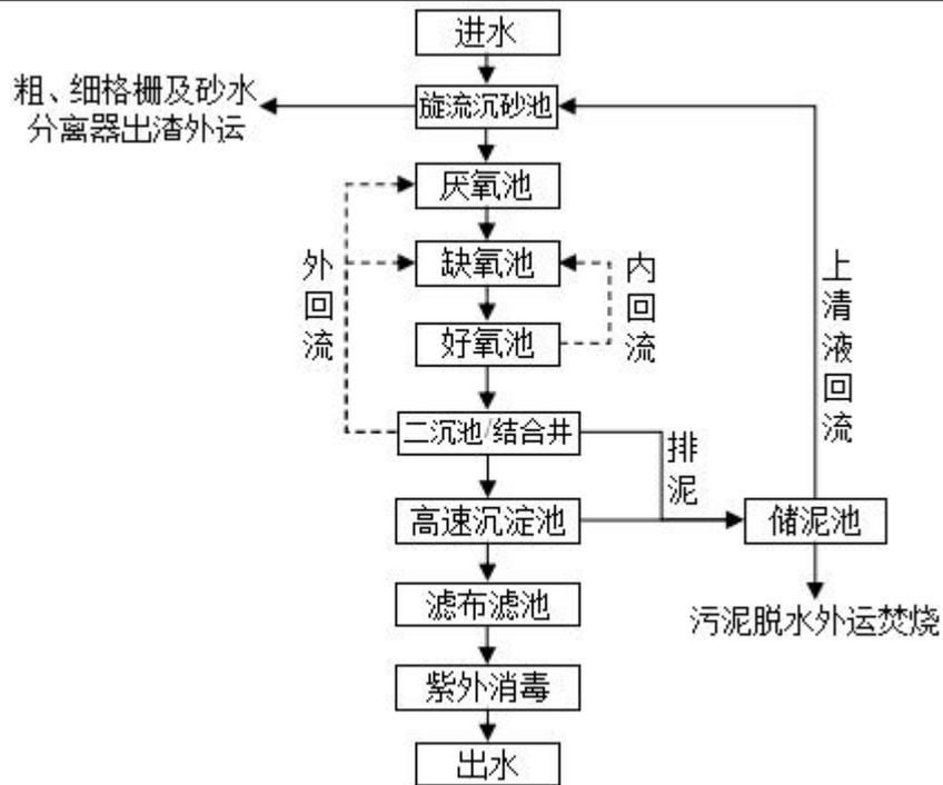
图 4-3 苏州市吴江桃源生活污水处理有限公司废水处理工艺流程图
