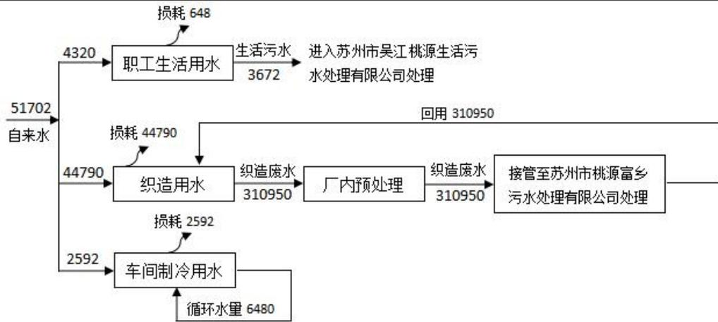
图 2-2 技改后全厂水平衡图（单位：t/a）
