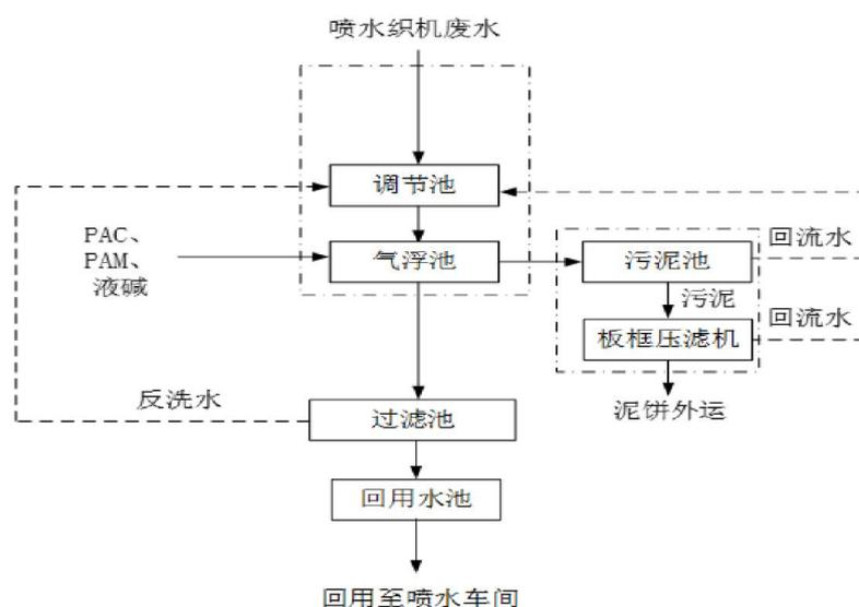
图 4-2 苏州市桃源富乡污水处理有限公司废水处理工艺流程图
