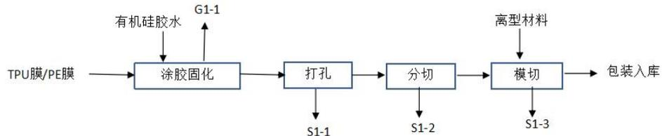
图 2-3 生产工艺流程及产污环节示意图 G-废气 S-固废
