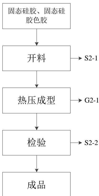
图 2-4 硅胶制品生产工艺流程图
