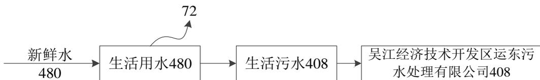
**图 2-5 原有项目水平衡 (t/a)**
