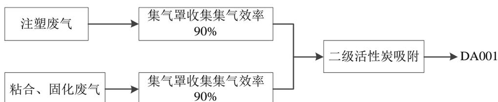
图 4-1 本项目废气处理流程图
