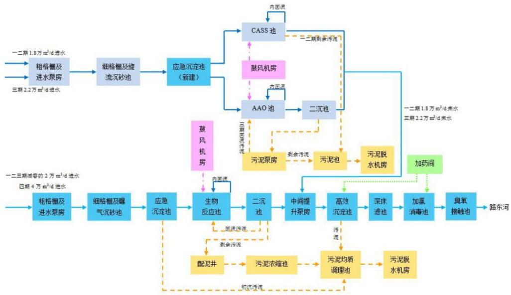
图 4-2 苏州市吴江开发区再生水有限公司污水处理工艺流程图
