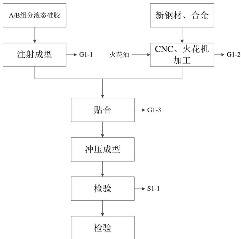
图 2-3 橡胶制品生产工艺流程图
