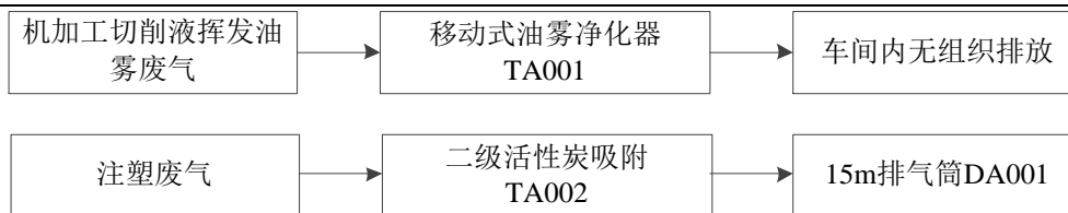
图 4-1 本项目废气处理流程图
