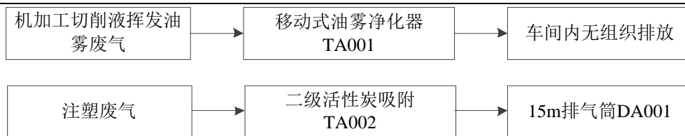
图 4-1 本项目废气处理流程图
