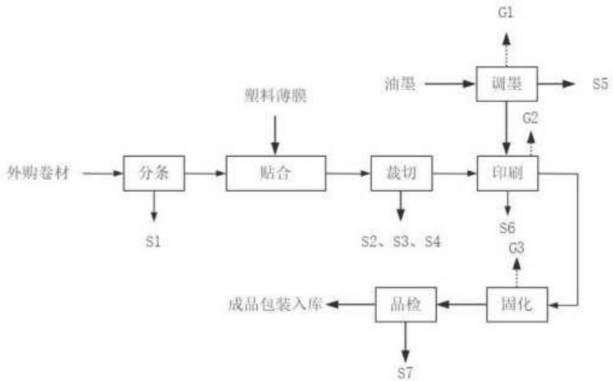
图 2-7 六期项目显示器印刷连接胶带裁切及印刷加工工艺流程图
