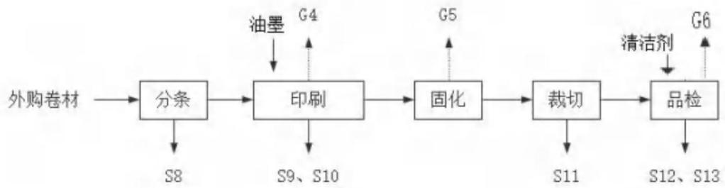
图 2-8 六期项目膜片裁切及印刷生产工艺流程图
