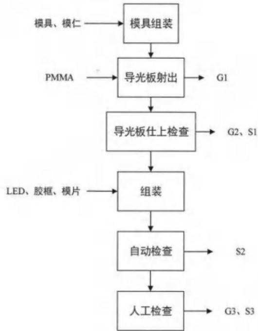
图 2-6 五期项目加工工艺流程图
