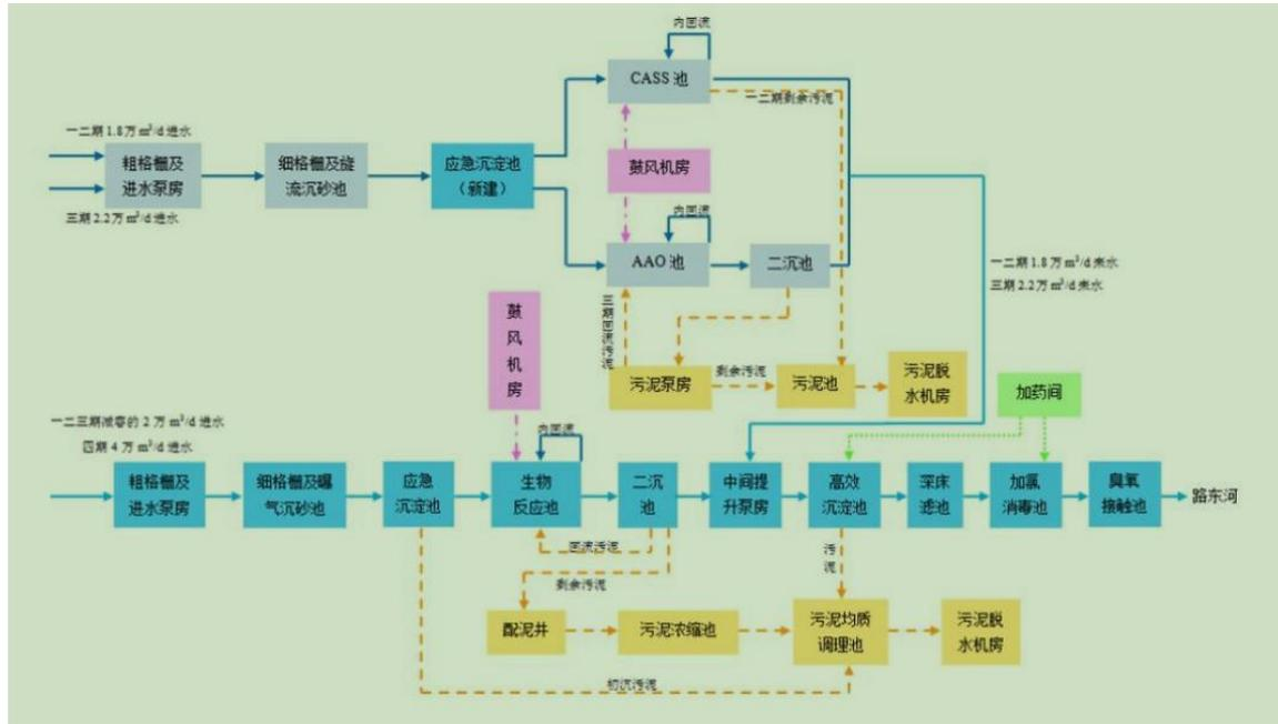
图 4-3 生活污水处理工艺流程图
