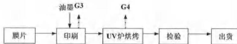
图 2-4 四期项目膜片印刷工艺流程图
