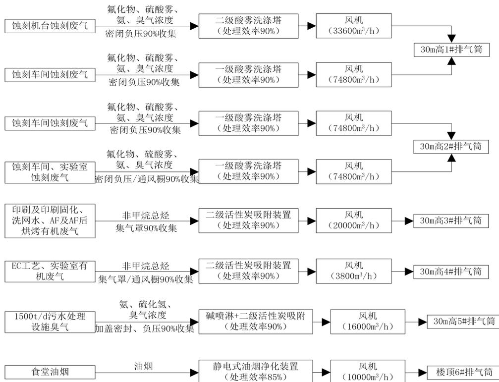
图 4-1 本项目废气收集走向示意图
