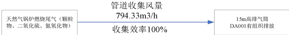
图 4-1 本项目废气处理流程图
