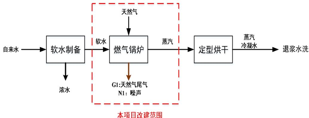
图 2-2 本项目工艺流程及产污环节图 单位 m<sup>3</sup>/a
