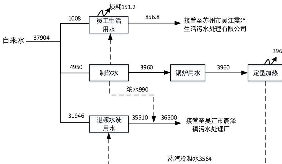
图 2-3 现有项目全厂水平衡图 单位 t/d
