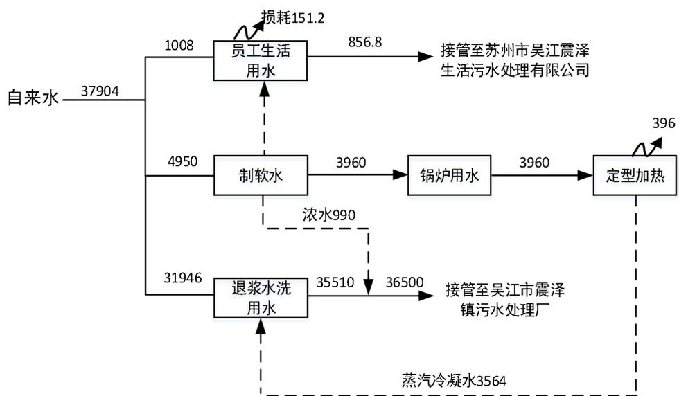
图 2-1 全厂水平衡图 (t/a)
