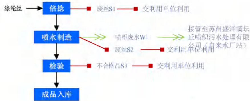
图 2-2 喷水织造生产工艺流程图
