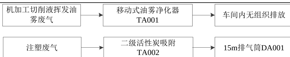
图 4-1 本项目废气处理流程图
