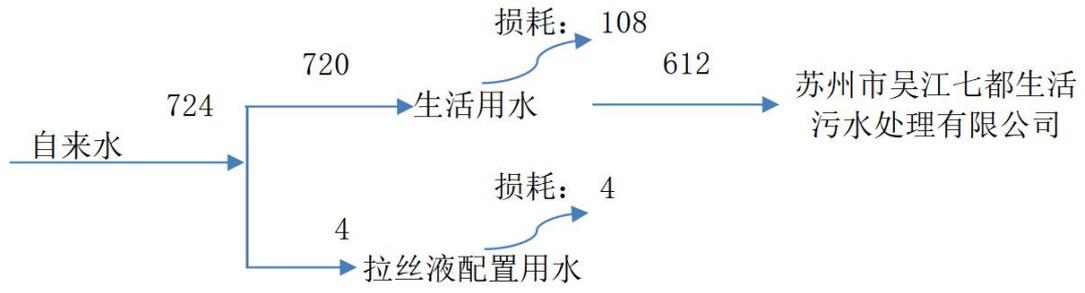
图 2-1 本项目水平衡图 t/a
