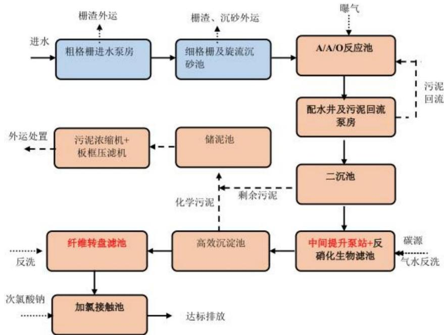
图 4-1 污水处理工艺流程图
