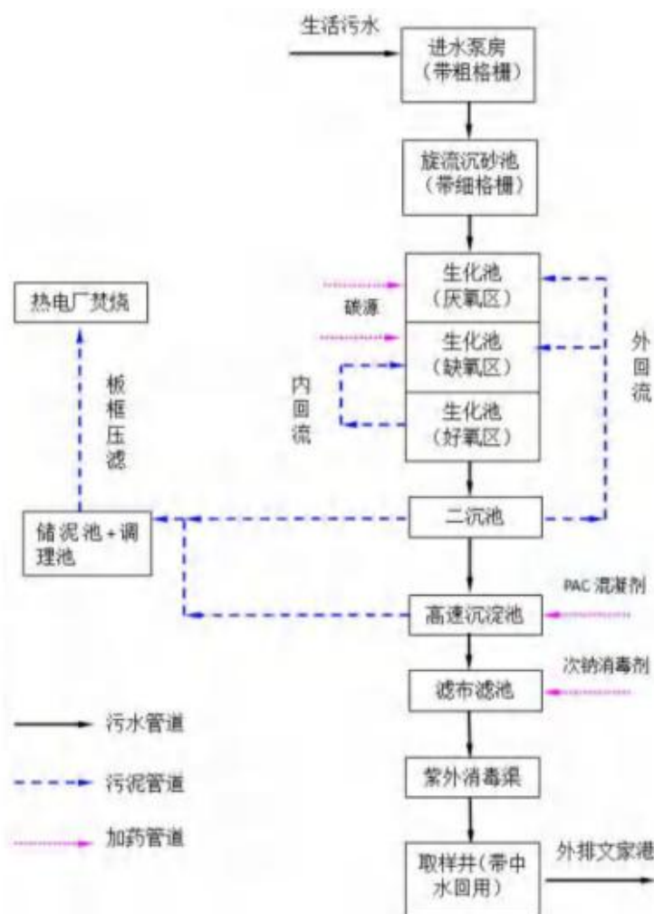
图 4-1 苏州市吴江桃源生活污水处理有限公司工艺流程图
