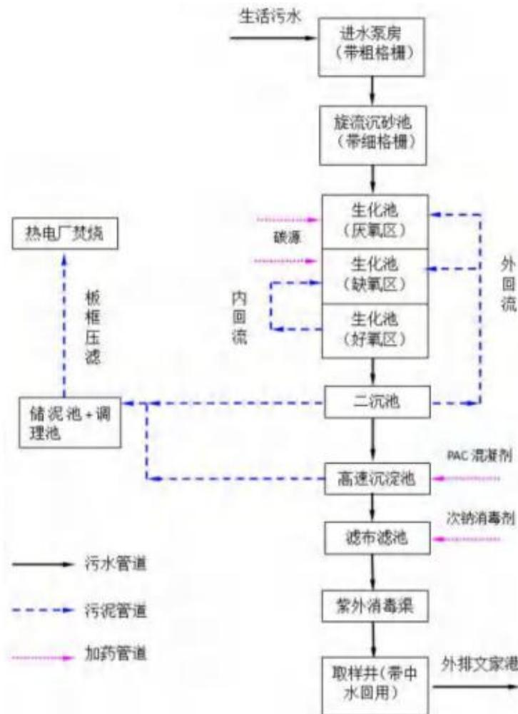
图 4-1 苏州市吴江桃源生活污水处理有限公司工艺流程图
