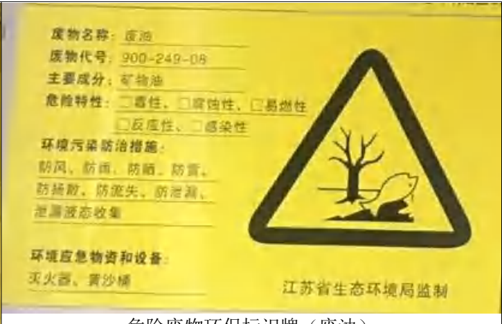
危险废物环保标识牌（废油）
