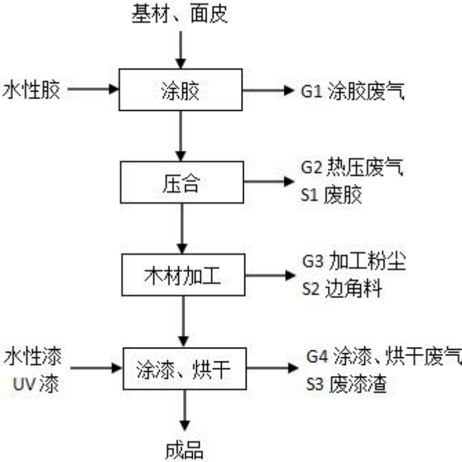
图 2-2 本次改建后生产工艺流程及产污环节图
