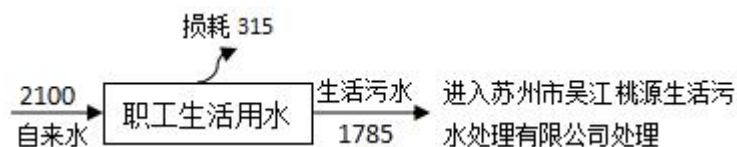
图 2-1 本次改建后全厂水平衡图（单位：t/a）
